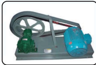
Bandas y Poleas a Motor Eléctrico.
